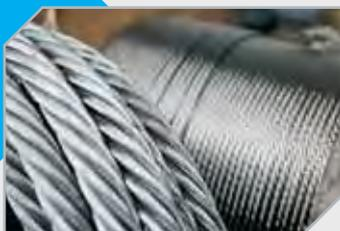
Стальной канат представляет собой механически сложное сочетание отдельных проволок, передающих усилие и движение в осевом направлении. Он является основным элементом большинства грузоподъемных, транспортных, дорожно-строительных, землеройных машин и механизмов, а также подвесных конструкций.
