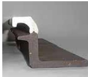
2. Металлические профили импортного производства являются, как правило, сварными, что приводит к разрушению металлопрофиля в месте сварки. При образовании колеяности покрытия риск разрушения профиля увеличивается из-за ударов колеса автомобиля в одну точку.
