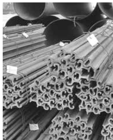
Фасонные профили для шпунтового замка производства «Северсталь-метиз» имеют длину от 4000 до 7000 мм в зависимости от площади сечения профиля.
