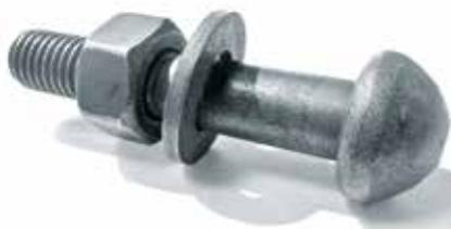
Высокопрочный крепеж М18, М22 с термодиффузионным цинковым покрытием по СТО 71915393-ТУ123-2012 с измененной геометрией головки, приближенной по форме к заклепке.
