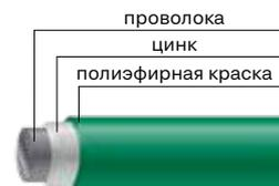
Специальная подготовка поверхности панелей перед покраской с применением т.н. нанокерамики позволяют достичь прочного сцепления слоёв покрытий цинка и полиэфирных красок, что является залогом привлекательного внешнего вида и повышенной стойкости в условиях неблагоприятного атмосферного воздействия.
